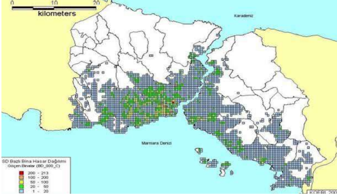
Şekil 2.10. Senaryo Depremi Sonucunda Bina Hasar Dağılımı – Göçecek Binalar
